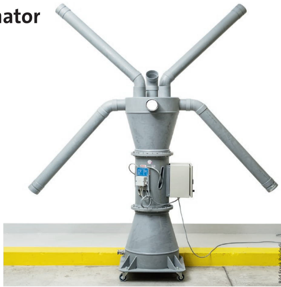
Macht Labore durch verdampftes H 2 O 2 keimfrei: Begasungsventilator der Abteilung Sicherheit und Umwelt.
