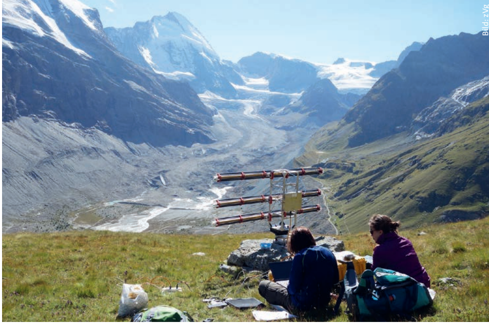
Forscherinnen des Geographischen Instituts oberhalb des Zmuttgletschers im Mattertal: Sie messen mit einem Radar die Bewegung des schuttbedeckten Gletschers.
